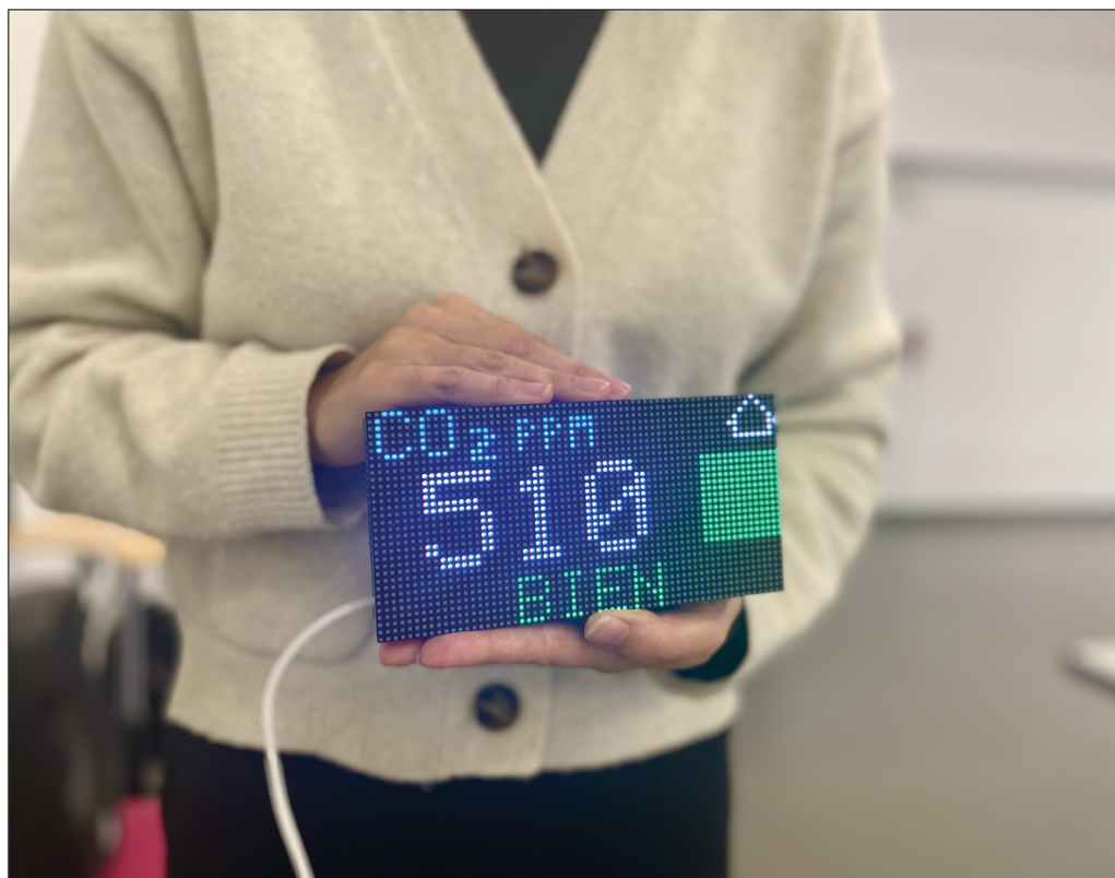
Le capteur mesure la température, le taux d'humidité, de particules fines, de CO 2 et de composés organiques volatils. Il permet notamment de savoir si la salle de classe manque d'aération. (Photo A. P.)
